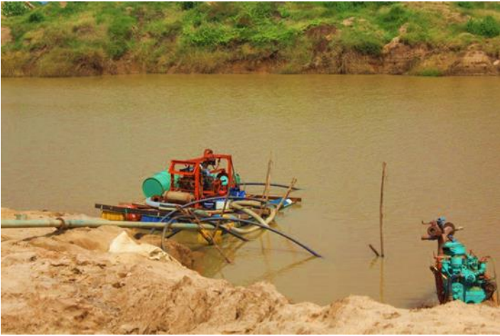
චූෂණ පොම්ප හා යන්ත්‍ර භාවිතා කරමින් වැලි නිස්සාරණය කරන අයුරු
